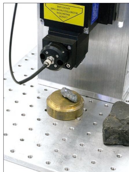
Bild 2: Industrielles LIBS-System auf Basis eines Mikrochiplasers
